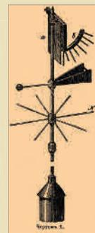
Флюгер Вильда – комбинированный метеорологический прибор для измерения направления и скорости ветра
