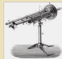
Полярископ Вильда (оптический сахарометр)
