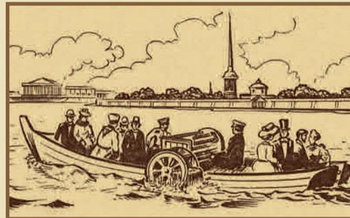
В 1838 году на реке Неве проведены испытания первого в мире электрохода-шлюпки. Двигатель шлюпки, созданный Б.С. Якоби, получал питание от батареи, состоявшей из 320 гальванических элементов.
