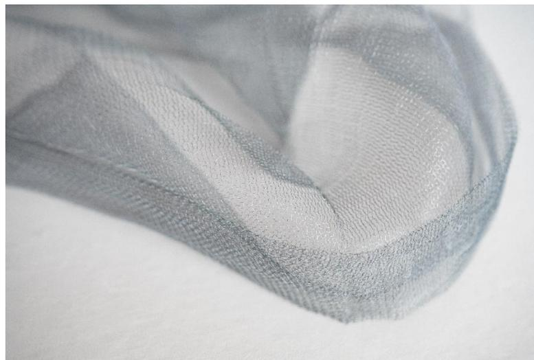
**Металлотрикотаж из тонкой никелид титановой проволоки для пластики подвижных тканей**
